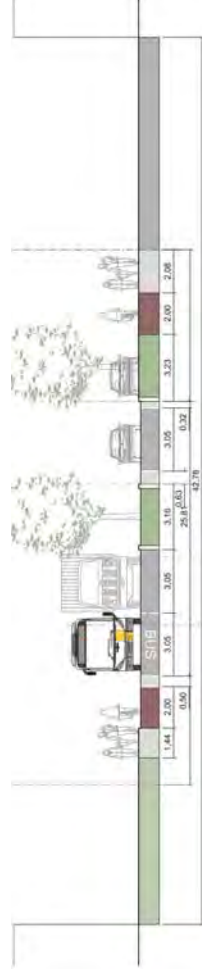
Figuur 50: snede met 1 busstrook in zuidelijke richting, fietspaden en groene middenberm en parkeerstrook / groene berm
