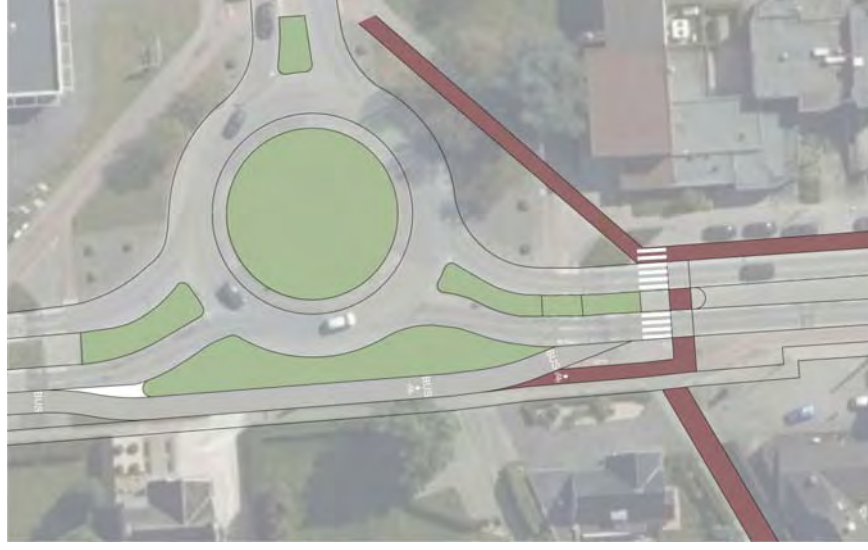
Figuur 52: bus-bypass rotonde Koning Leopold III-laan
